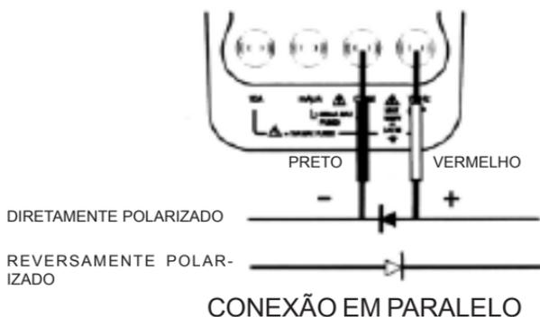
A queda de tensão típica para um diodo de silício em bom estado está entre 0.4V e 0.9V. Uma leitura maior indica um diodo defeituoso (aberto). Uma leitura igual a zero indica um diodo em curto. Uma leitura de OL indica um diodo aberto.
