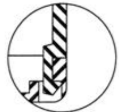
DETALHE DO FECHAMENTO AUTO-TRAVANTE EM CORTE ESCALA 3:1
