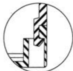
DETALHE DO FECHAMENTO AUTO-TRAVANTE EM CORTE ESCALA 3:1
