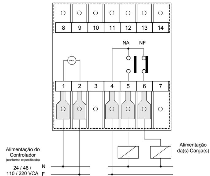
SUGERE-SE A INSTALAÇÃO DE SUPRESSORES DE TRANSIENTES (FILTRO RC) EM BOBINAS DE CONTADORES E EM SOLENÓIDES.
