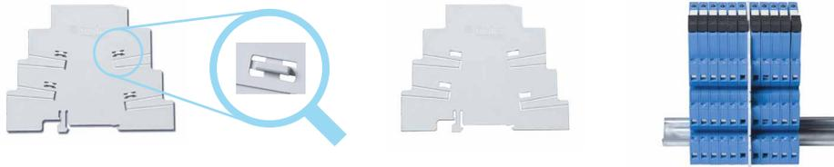
2. Não rompendo as saliências, este separador oferecerá 6.2 mm de espessura. Com a ajuda de uma tesoura, pode-se cortar no local indicado, permitindo a interligação, através do separador, com a utilização do pente de ligação, de 2 grupos diferentes de relés de interface.
