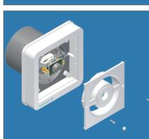
Desparafuse e retire a moldura frontal.
