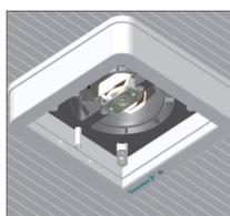
Insira o corpo motor no forro e fixe com os parafusos.
