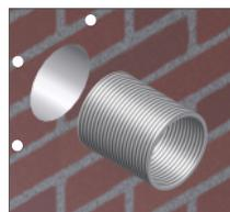
Estique o tubo e introduza-o na parede. Corte com uma faca as rebarbas caso seja necessário.
