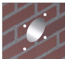
Com a furadeira faça os furos para colocar as buchas. Depois, com o auxílio de uma serra copo ou outra ferramenta, faça a abertura na parede.
