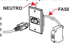
Para ligação em rede bifásica recomenda-se utilizar o dispositivo de proteção para cada uma das fases.
