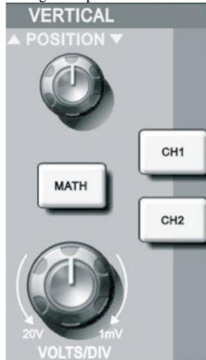
Figura 1-9 Área de Controle Vertical do Painel Frontal
