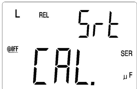
d. Após a calibração o RLC-510 voltará ao modo normal de medição.
