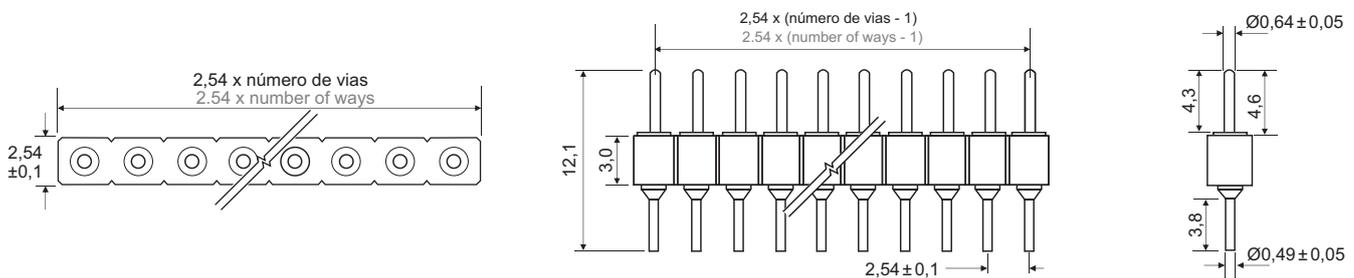
Tolerâncias não indicadas  $\pm 0,2\text{mm}$  / Not indicated tolerance  $\pm 0.2\text{mm}$
