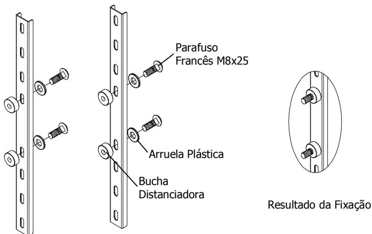
**Instalação das Hastes no televisor:** Fixe as hastes em furações apropriadas existentes na parte traseira do televisor/monitor. Utilize para isso os parafusos que acompanham o kit do suporte. **Caso os parafusos não sejam compatíveis com o televisor, providencie parafusos adequados.** Utilize as Buchas Distanciadoras entre o televisor/monitor e o suporte.
