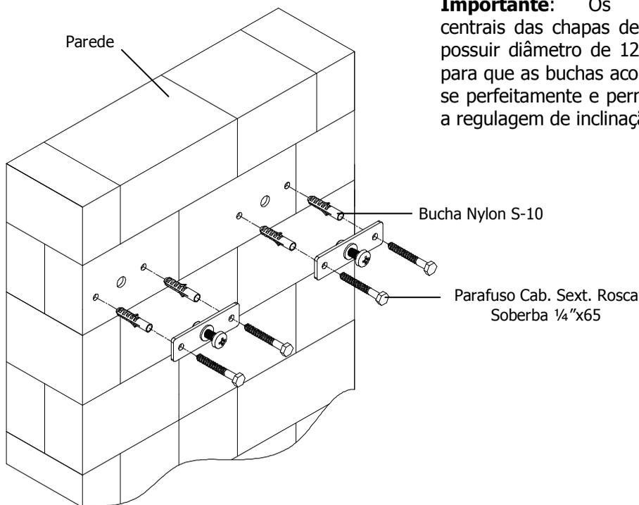
**Importante:** Os furos centrais das chapas deverão possuir diâmetro de 12 mm, para que as buchas acoplem-se perfeitamente e permitam a regulação de inclinação.
