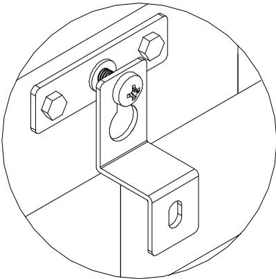
**Observação:** As Buchas servirão de Apoio para o televisor/monitor na parede.
