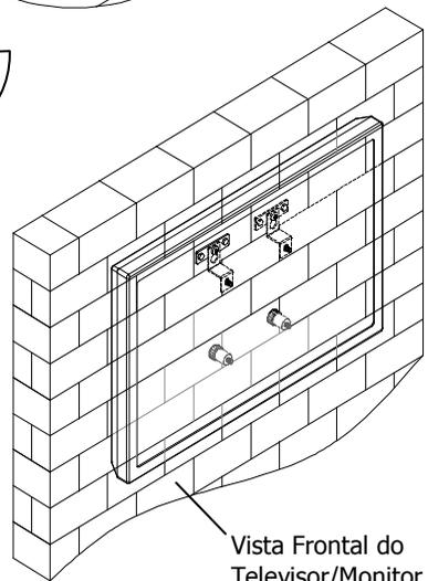
**CORREÇÃO DE NIVELAMENTO E AJUSTE:** Após a fixação, caso o televisor/monitor fique horizontalmente desnivelado, promova as devidas correções deslocando as Bases de Sustentação conforme sua necessidade.
