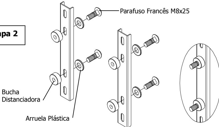
**Instalação das Hastes no televisor:** Fixe as hastes em furações apropriadas existentes na parte traseira do televisor/monitor. Utilize para isso os parafusos que acompanham o kit do suporte. **Caso os parafusos não sejam compatíveis com o televisor, providencie parafusos adequados.** Utilize as Buchas Distanciadoras entre o televisor/monitor e o suporte.
