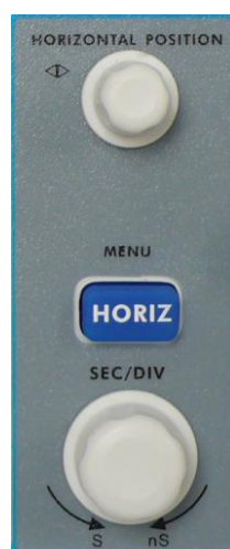
Figura 4-12 Área de Controle Horizontal
