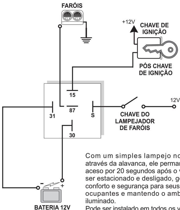
Com um simples lampejo no farol através da alavanca, ele permanecerá aceso por 20 segundos após o veículo ser estacionado e desligado, gerando conforto e segurança para seus ocupantes e mantendo o ambiente iluminado.
