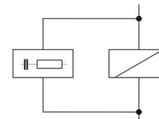
SUGERIMOS A INSTALAÇÃO DE SUPRESSORES DE TRANSIENTES, (FILTROS RC) EM BOBINAS DE CONTADORAS E EM SOLENÓIDES.
