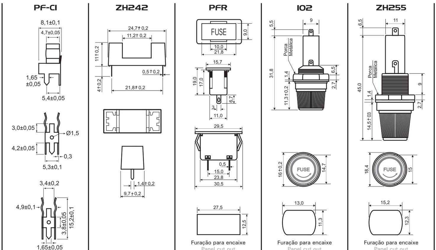
Todas as dimensões em milímetros / All dimensions in millimeters
