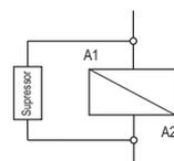
A1 e A2 são os borne da bobina da contatora.
