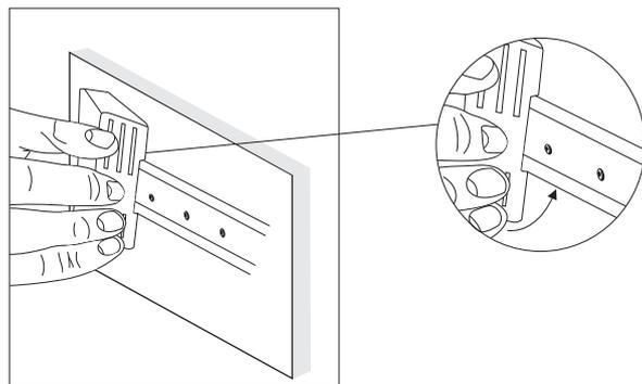
11.2.3 - Para retirar a Interface do trilho DIN utilize uma chave compatível com o tamanho da trava para fazer uma alavanca.
