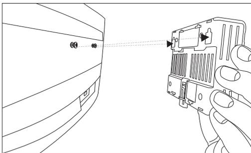
11.1.2 - Após posicionar a Interface, empurre-a para baixo para fixá-la.
