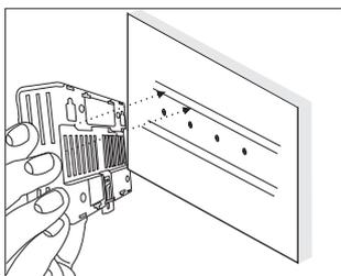
11.2.2 - Após faça o encaixe da parte inferior e verifique se a trava está bloqueada.
