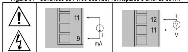
**Figura 05** - Conexões de sinais de corrente (mA) e tensão (V)
