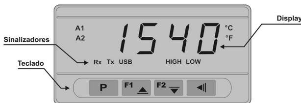
**Figura 08** - Identificação das partes do painel frontal
