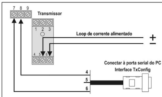
Fig. 4 – Conexões do Cabo TxConfig – Alimentação pelo loop
