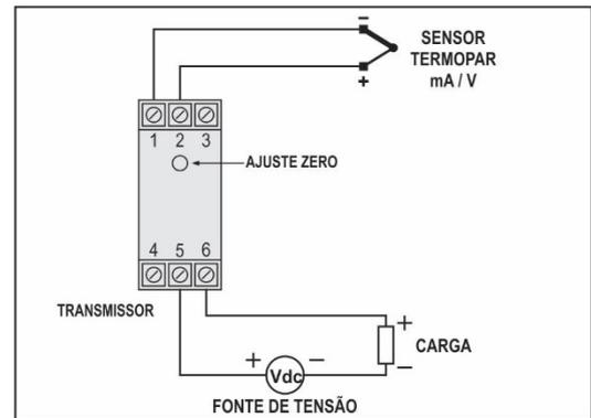
Fig. 7 – Conexões elétricas do transmissor – Termopar / mA / V
