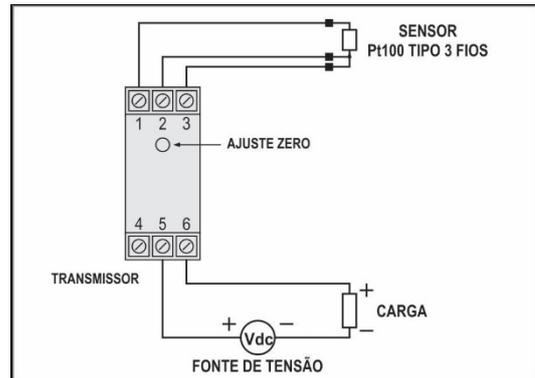
Fig. 6 – Conexões elétricas do transmissor – Pt100
