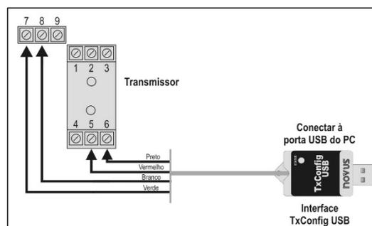
Fig. 2 – Conexões da Interface TxConfig modelo USB
