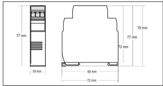
Fig. 5 – Dimensões do transmissor
