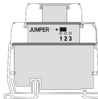
Fig. 8 – Jumper para entrada 0-10 Vcc
