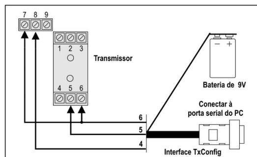
Fig. 1 – Conexões da Interface TxConfig modelo RS232
