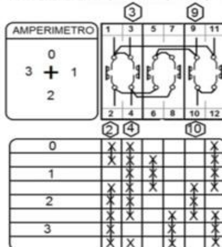
Chave LW26-20 LH3/3 (comutador para Amperímetro com 3 TC's)
