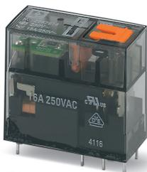
Relé miniatura plugável, com contato de potência, 1 contatos reversíveis, botão de teste, indicação de posição de ligação mecânica, LED de estado, tensão de entrada 230 V AC
