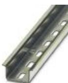
Trilho de fixação perfurado, Perfil padrão, largura: 35 mm, altura: 15 mm, semelhante à EN 60715, material: Aço, galvanizado, bicromatizado, comprimento: 2000 mm, cor: cores prat.
