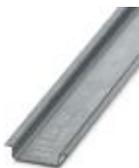
Trilho de fixação não perfurado, Perfil padrão, largura: 35 mm, altura: 7,5 mm, de acordo com EN 60715;, material: Aço, galvanizado, comprimento: 2000 mm, cor: cores prat.
