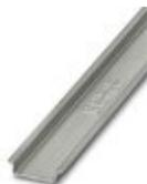
Trilho de fixação não perfurado, Perfil padrão, largura: 35 mm, altura: 7,5 mm, de acordo com EN 60715:, material: Aço, galvanizado, bicromatizado, comprimento: 2000 mm, cor: cores prat.
