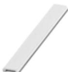
Tira Zack plana, Fitas, branco, não impresso, identificável com: PLOTMARK, CMS-P1-PLOTTER, tipo de montagem: travamento em ranhura plana de plaqueta, para a largura de terminal: 5 mm, tamanho para gravação: 5,1 x 5,2 mm, Quantidade de plaquetas de identificação: 10
