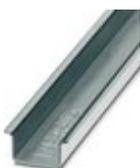
Trilho de fixação não perfurado, Perfil padrão, largura: 35 mm, altura: 15 mm, semelhante à EN 60715, material: Aço, galvanizado, com passivação em branco, comprimento: 2000 mm, cor: cores prat.
