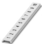
Tira Zack plana, Fitas, branco, identificado, impresso horizontalmente: números consecutivos 1 ... 10, 11 ... 20 etc. até 491 ... 500, tipo de montagem: travamento em ranhura plana de plaqueta, para a largura de terminal: 5 mm, tamanho para gravação: 5,15 x 5,15 mm, Quantidade de plaquetas de identificação: 10
