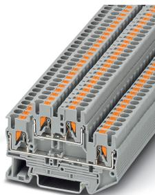
Bornes de dois níveis, tipo de conexão: Conexão Push-in, perfil de conexão: 0,14 mm<sup>2</sup> - 4 mm<sup>2</sup>, AWG: 26 - 12, largura: 5,2 mm, cor: cinza, tipo de montagem: NS 35/7,5, NS 35/15
