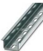
Trilho de fixação perfurado, Perfil padrão, largura: 35 mm, altura: 15 mm, semelhante à EN 60715, material: Aço, galvanizado, com passivação em branco, comprimento: 2000 mm, cor: cores prat.
